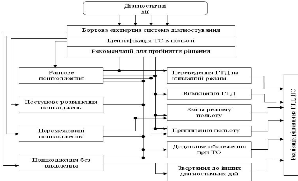
Рис. 2. Схема використання ЕС діагностування в процесі льотно-технічної експлуатації ГТД (I етап діагностування ГТД)
