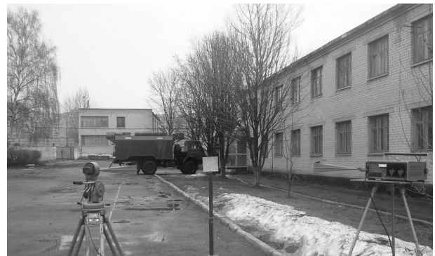
Рис. 3. Внешний вид установки для измерения мощности отраженного сигнала на частоте 10 ГГц
