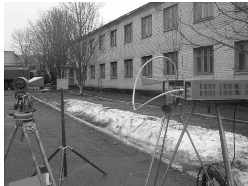
Рис. 4. Внешний вид установки для измерения мощности отраженного сигнала на частоте 37,5 ГГц
