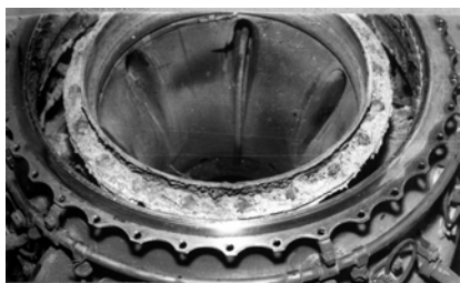
Рис. 3. Полное выгорание внутреннего кольца и лопаток направляющего аппарата 8 ступени
