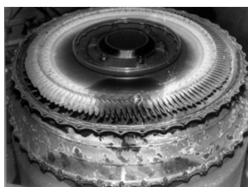
Рис. 4. Обрыв всех бандажных полок, деформация перьев лопаток на рабочем колесе ТВД
