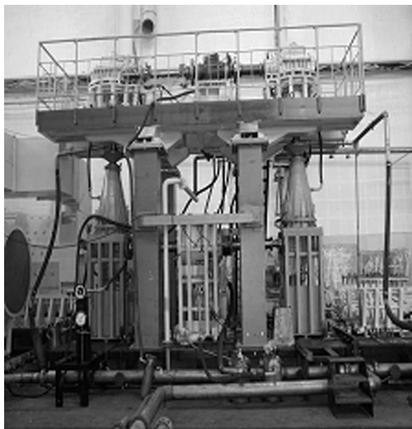
Рис. 4. Универсальный стенд для испытаний угловых редукторов
