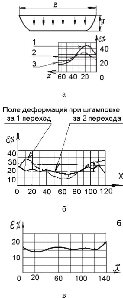
Рис. 4. Выравнивание поля деформаций специальными приемами:
