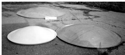
Рис. 4. Параметры деталей – параболических рефлекторов: а – параметры рефлекторов; б – отштампованные детали
