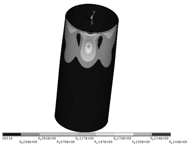
Рис. 5. Напряженно-деформированное состояние цилиндра под действием локальной ударной нагрузки
