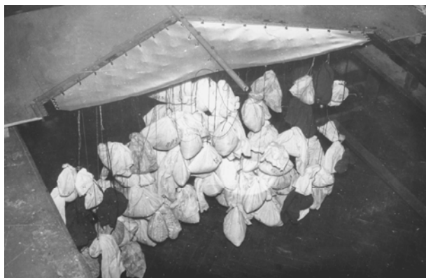
Рис. 5. Первые статические испытания гибкого крыла
