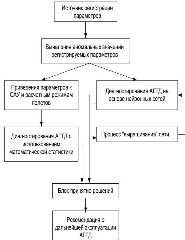
Рис. 1. Обобщенная схема комплексной системы диагностирования АГТД
