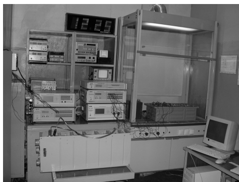
Рис. 8. Автоматизированный стендовый комплекс для диагностирования и испытаний электрохимических аккумуляторов
