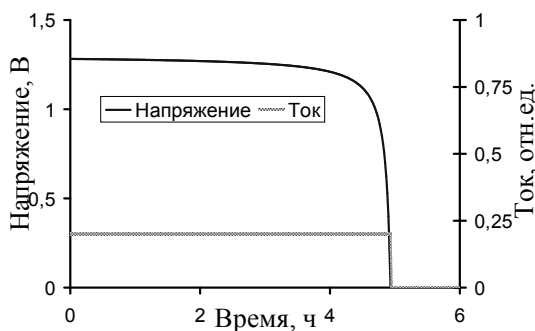
Рис. 2. Разрядная характеристика НКГ АК и зависимость тока от времени при разряде постоянным стабилизированным током
