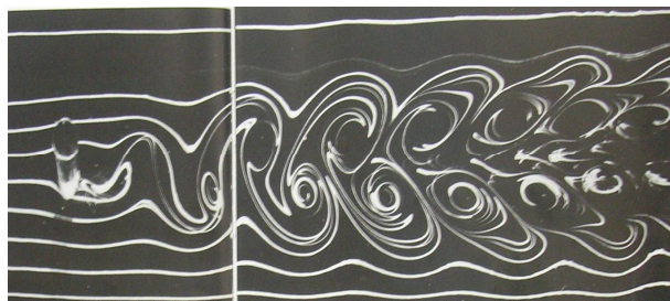
Рис. 3. Вихревая дорожка Кармана за круговым цилиндром [8]
