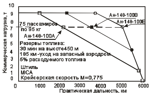
Рис. 1. Семейство модификаций самолета Ан-148, разрабатываемых на основе модульного метода: Ан-148-100А, Ан-148-100В, Ан-148Е
