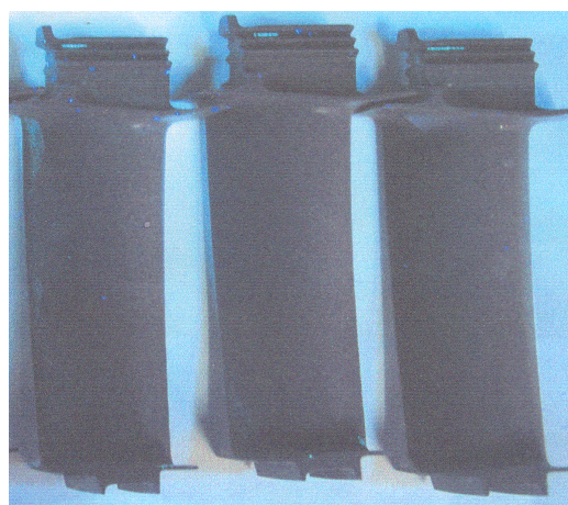
Рис. 2. Трещина в сечении III-III хвостовика рабочей лопатки турбины
