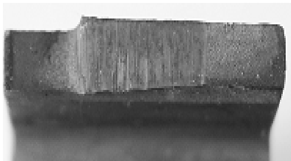
Рис. 3. Вид глазурированной поверхности на контактной плоскости образца после износостойких испытаний
