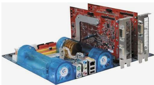
Рис. 2. Принудительная вентиляция платы
