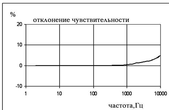
Рис. 2. Температурная и частотная характеристика датчика СР235
