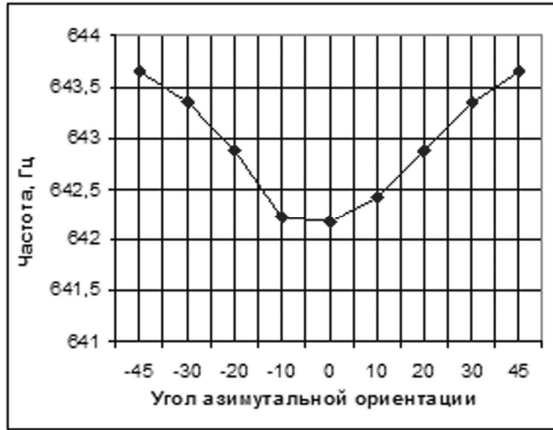
Рис. 3. Изменение первой собственной частоты в зависимости от изменения угла азимутальной ориентации. Преимущественно изгибные колебания
