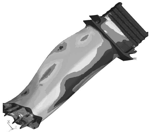
Рис. 6. Форма колебаний с наложенными полями распределений интенсивности напряжений (преимущественно изгибно-крутильные колебания)
