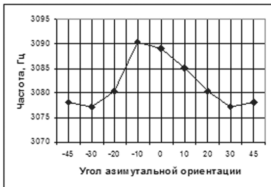
Рис. 4. Изменение третьей собственной частоты в зависимости от изменения угла азимутальной ориентации (преимущественно крутильные колебания)
