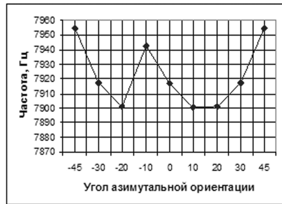
Рис. 5. Изменение шестой собственной частоты в зависимости от изменения угла азимутальной ориентации. Преимущественно изгибно-крутильные колебания
