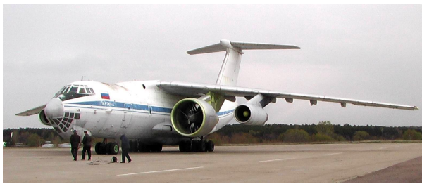
Рис. 4. Летаящая лаборатория Ил-76ЛЛ с двигателем НК-93
