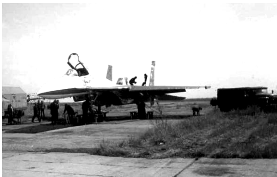
Рис. 8. Самолет Су-27 на динамометрическом стенде тяги
