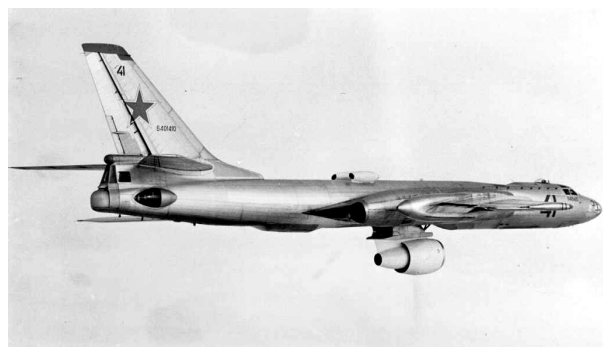
Рис. 1. Летающая лаборатория Ту-16 с двигателем Д-36
