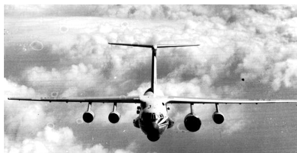
Рис. 2. Летающая лаборатория Ил-76 с двигателем Д-18Т
