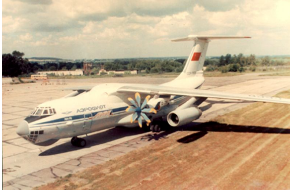
Рис. 3. Летаящая лаборатория Ил-76ЛЛ с двигателем Д-27
