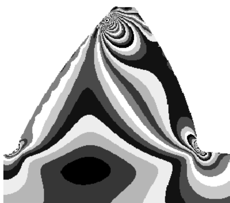
Рис. 5. Несимметричный зуб: a – фотоупругая модель; b – изолинии напряжений, определенные МКЭ
