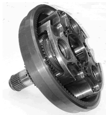
Рис. 7. Эпицикл и водило первой ступени в сборе
