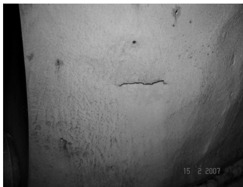
Рис. 2. Индикаторный след подповерхностной трещины, обнаруженной методом МПД в корпусе нагнетателя Н-370-18-1
