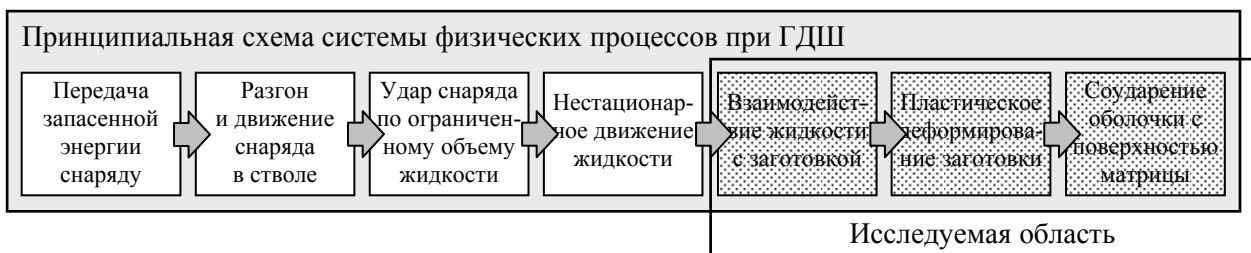
Рис. 1. Процесс ГДШ как взаимосвязанная система физических явлений
