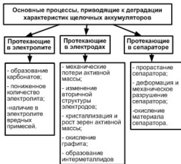
Рис. 1. Деградационные процессы, приводящие к истечению ресурса АК
