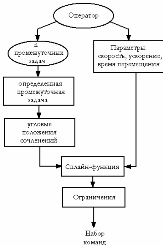
Рис. 5. Блок-схема формирования команд в режиме автономного управления ДПЛА для оперативного природоресурсного и экологического мониторинга окружающей среды
