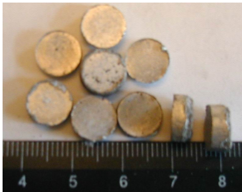
Рис. 1. Прессованные таблетки для модифицирования
