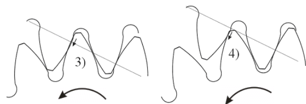
Рис. 7. Движение зубьев при выходе из зацепления: 3 – на завершающем этапе касания зубьев волна деформаций на ведомом зубе направлена к вершине; 4 – в процессе кромочного контакта на выходе зубьев волны деформаций перемещают поверхностные слои внутрь активной поверхности зуба
