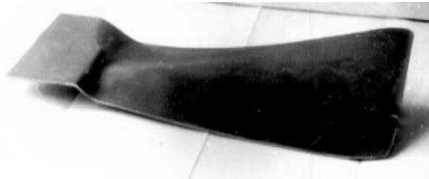
Рис. 4. Лопатка после термофиксации и отделения припуска
