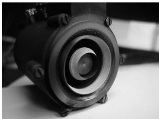
Рис.1. Модифицированный МСПД после 83 часов и 38 минут работы
