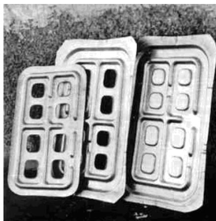
Рис. 4. Панель, изготовленная совмещением методов штамповки
