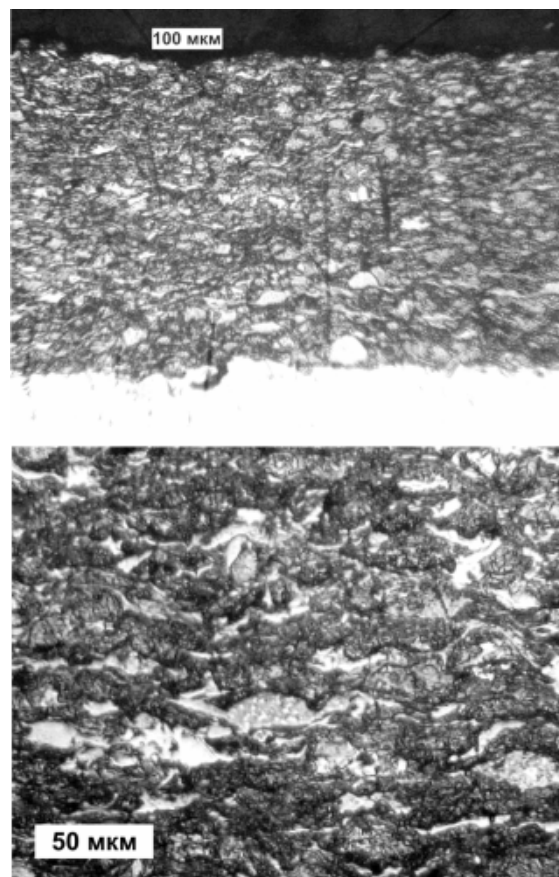
Рис. 2. Микроструктура покрытия ПН85Ю15 при различном увеличении (травленный шлиф)
