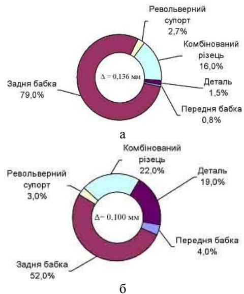
Рис. 6. Вплив пружних переміщень елементів технологічної системи на похибку обробки комбінованим різцем: d = 64 мм; L_A = 45 мм; L_P = 30 мм; а – L = 500 мм; б – L = 220 мм
