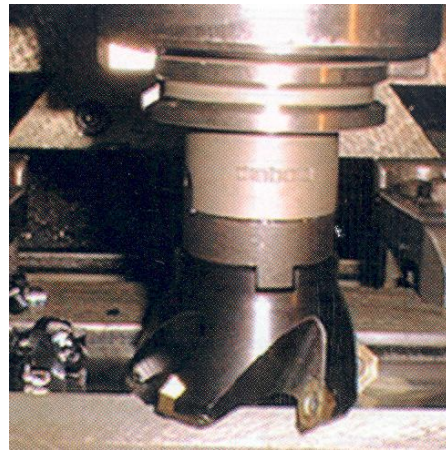
Рис. 8. Крепление катушечной фрезы в инструментальном модуле HSK-63A
