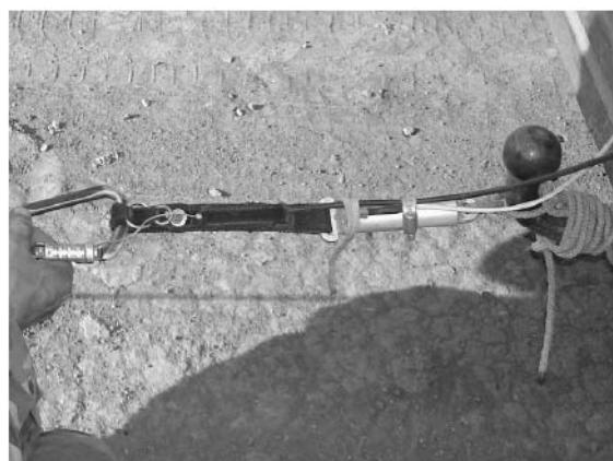
Рис. 8. Тензодатчик буксировочной системы устанавливается на автомобиль
