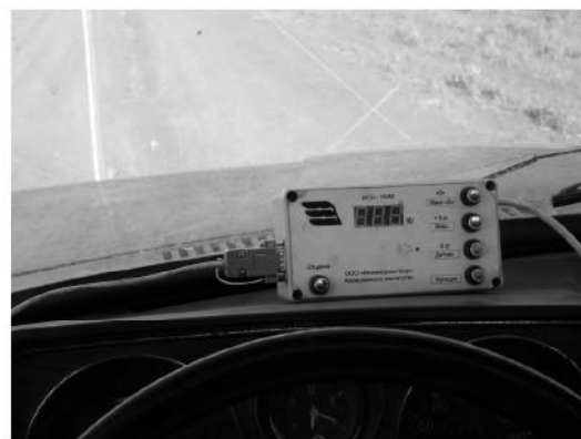
Рис. 9. Электронный блок буксировочной системы устанавливается на автомобиль
