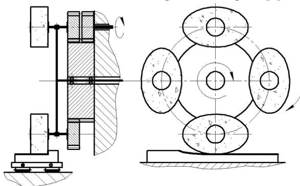
Рис. 1. Способ глубинного планетарного шлифования плоских поверхностей
