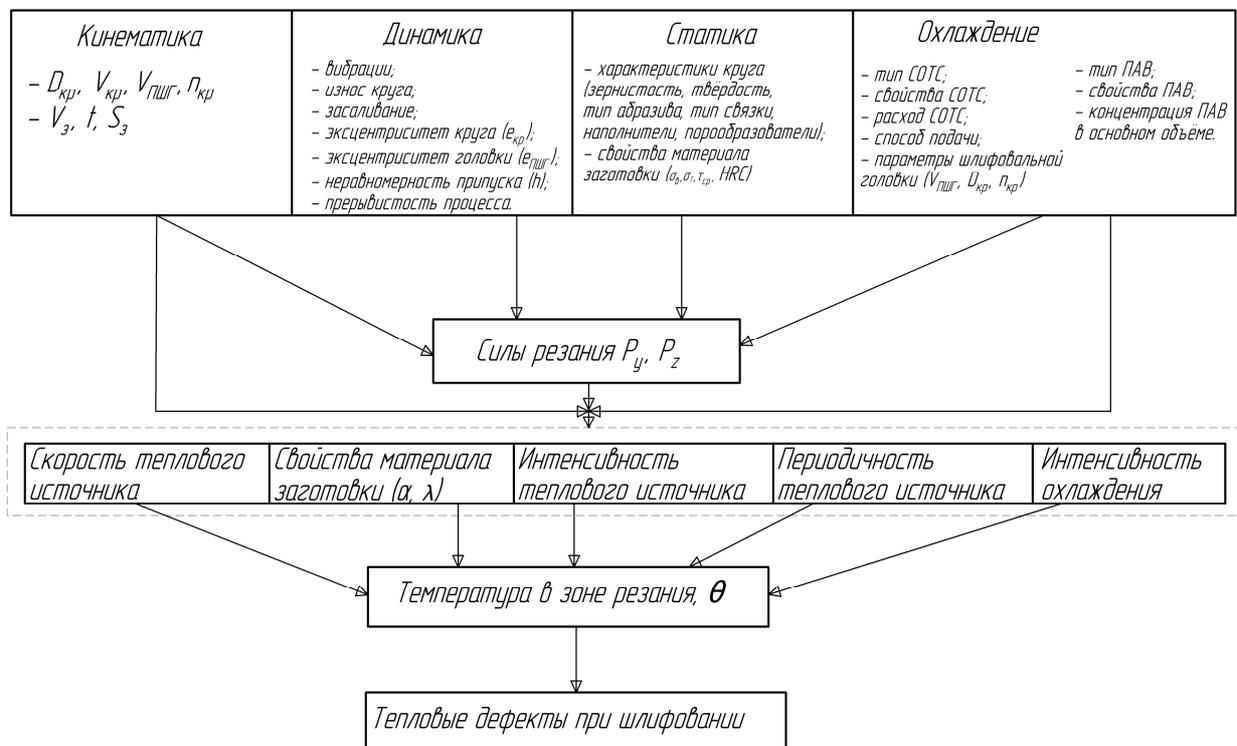
Рис. 3. Классификация процессов, определяющих возникновение тепловых дефектов
