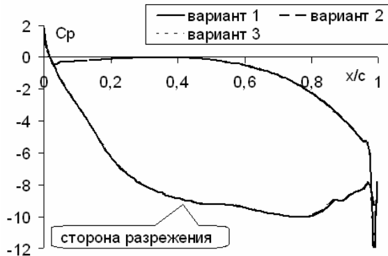
Рис. 3. Распределение усредненного по времени давления по хорде лопатки
