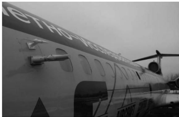
Рис. 3. Датчики на ЛЛ Ту-154М
