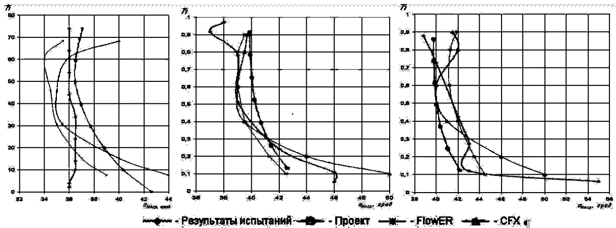
Рис. 7. Эпюры изменения угла потока в межлопаточном канале НА по высоте вдоль проточной части компрессора (1-я, 5-я и 6-я ступени соответственно)
