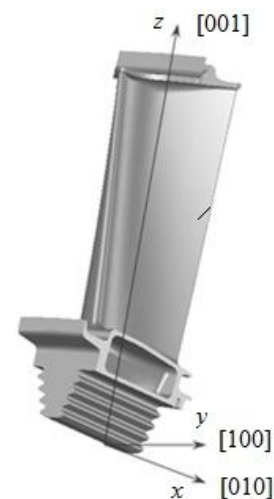
Рис. 1. Геометрия лопатки и схема расположения осей КГО [100], [010], [001] при совпадении с осями x , y , z
