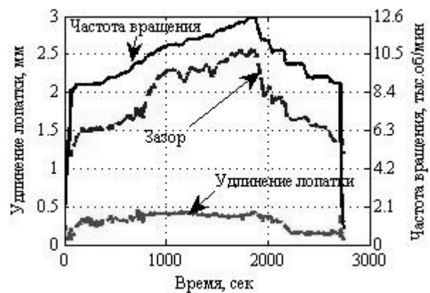
Рис. 5. Результаты стендовых испытаний при измерениях на КВД газогенератора (частота вращения, зазор и удлинение лопатки)
