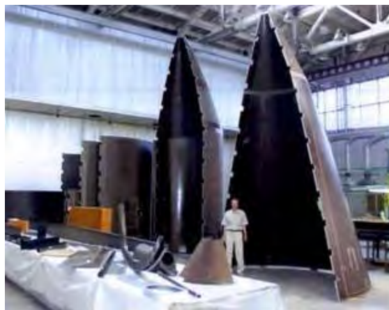
Рис. 15. Элементы конструкций ракетно-космической техники из композиционных материалов
