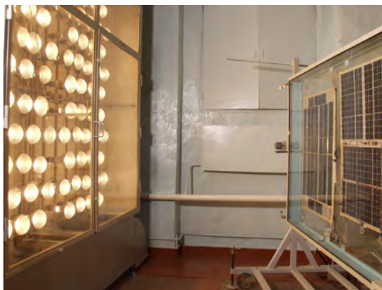
Рис. 9. Стенд для испытания панелей фотоэлектрических батарей в лаборатории автономной энергетики МНТЦ КЭД ХАИ
