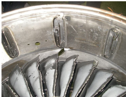
Рис. 5. Корпус вентилятора с рабочим колесом после испытаний
