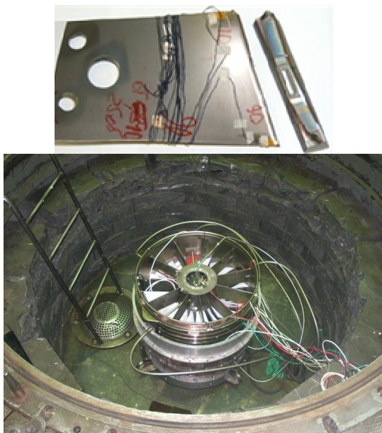
Рис. 4. Корпус вентилятора с рабочим колесом перед испытаниями
