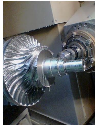
Рис. 13. Чистовая обработка ЦБК на станке Turboblisk 1005
