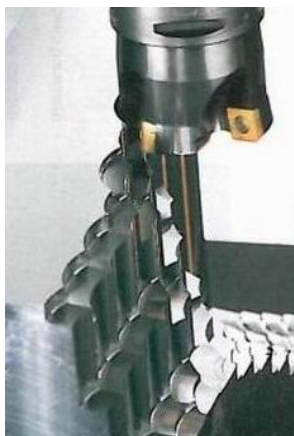
Рис. 2. Процесс плунжерного фрезерования
