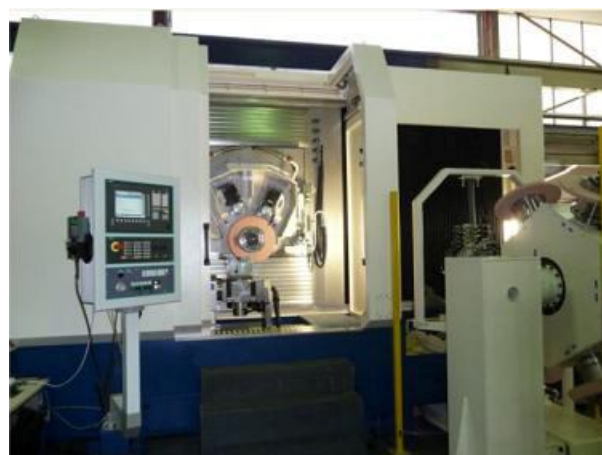
Рис. 3. Общий вид многокоординатного станка ELB-SCHLIFF Micro Cut4-520
