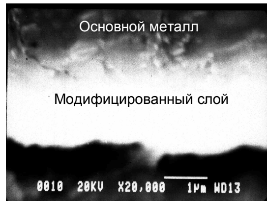
Рис. 3. Структура модифицированного слоя поверхности после электролитно-плазменной обработки
