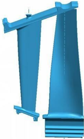
Рис. 5. Геометрическая модель сектора 4-й ступени турбины
