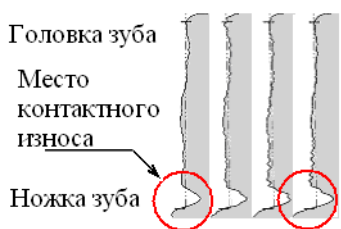
Рис. 3. Эвольвентограммы колес после ресурсных испытаний
