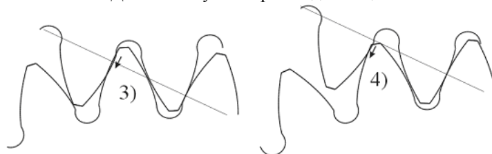
Рис. 2. Движение зубьев при выходе из зацепления
