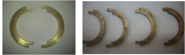
Рис. 6. Компрессионные кольца поршневого уплотнения, слева – два полукольца одного полного кольца, справа – полукольца для комплектного поршневого уплотнения
