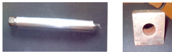
Рис. 2. Линейный подшипник скольжения, слева – поршневой шток (сталь, цементирование), справа – втулка (меднографит)
