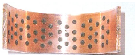
Рис. 8. Опытный вкладыш подшипника скольжения из меди с внедрением графита
