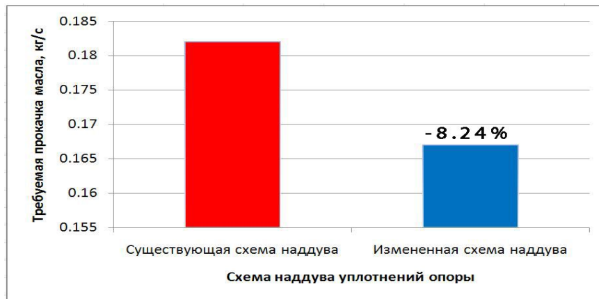
Рис. 9. Изменение прокачки масла через опору компрессора для двух вариантов
