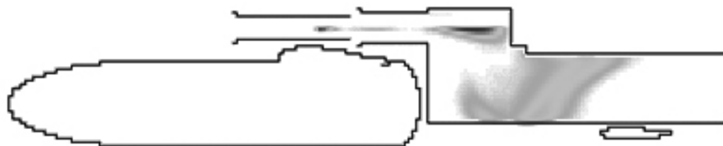
Рис. 4. Мерцающие очаги горения в падающей струе пропана и струе пропана в сопле
