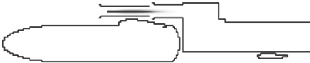
Рис. 2. Импульсная синхронная подача воздуха и пропана (в струе пропана налету активируется реакция окисления в самом начале внешнебаллистического участка)
