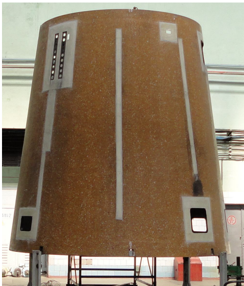
Рис. 3. Межступенчатый отсек из ПКМ
