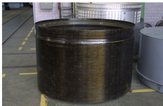
Рис. 2. Хвостовой отсек из углепластика
