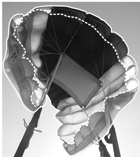
Рис. 3. Случай перекоса слайдера на стропах
